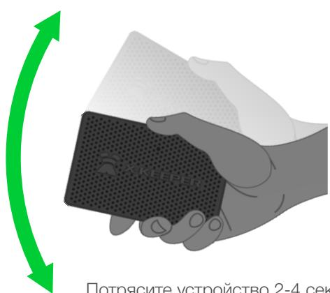
\* Если продолжать трясти при индикации **красного** светодиода (более 4-х секунд), устройство включается (активируется).
