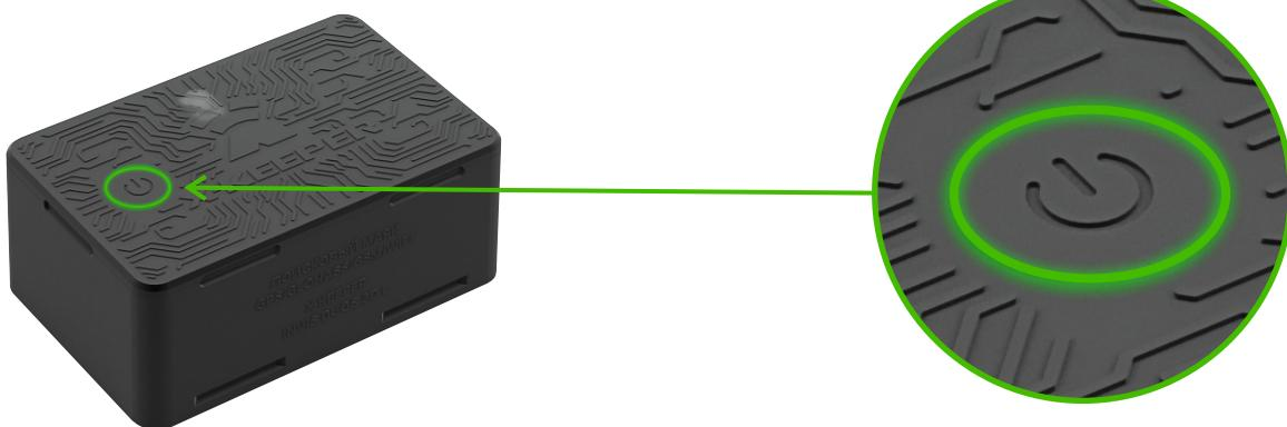
Крышка устройства более прозрачная в области, где на плате расположены светодиоды.
