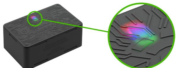
**2.** После успешного перезапуска активированного устройства, продолжится мигание одного **зелёного** светодиода.
